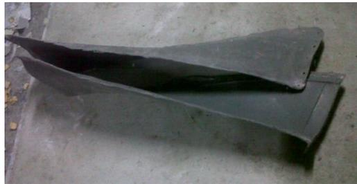
Gambar. Cetakan sudu turbin Gorlov NACA 0018
